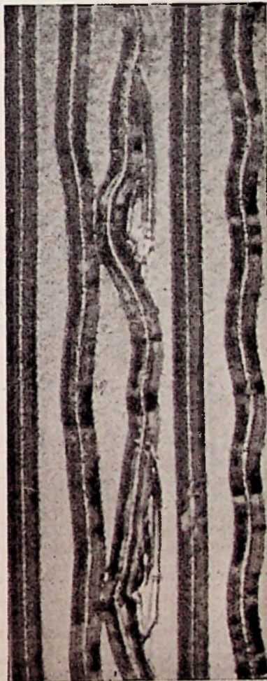
GROEF VAN DE LP „BOUTIQUE FANTASQUE”, beschadigd door afspelen met 7,5 g verticale druk. De saffier kan de groef niet volgen en „sneet de bocht af” over een afstand van 1,25 mm.
